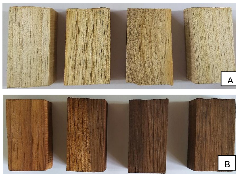
Figura 2 – Corpos-de-prova termorretificados: (A) Pós tratamento térmico na temperatura de 140 °C; (B) Pós tratamento térmico na temperatura de 200 °C.
